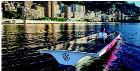
Lo scafo delle imbarcazioni è rivestito da celle fotovoltaiche
